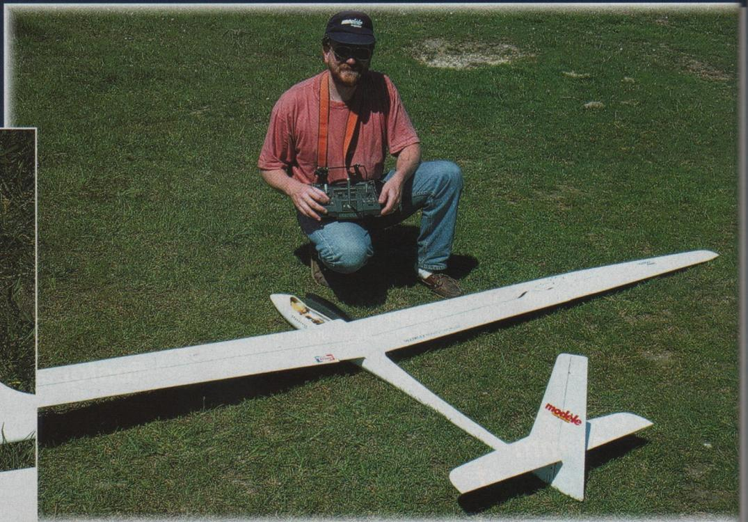
Le montage du planeur sur le terrain est rapide grâce à l'emploi d'une clé flottante : le fuselage est ainsi porté par quatre tétons de calage mais ne subit pas les contraintes des ailes en vol (ailes reliées par une solide clé en acier de 12 mm de diamètre).
