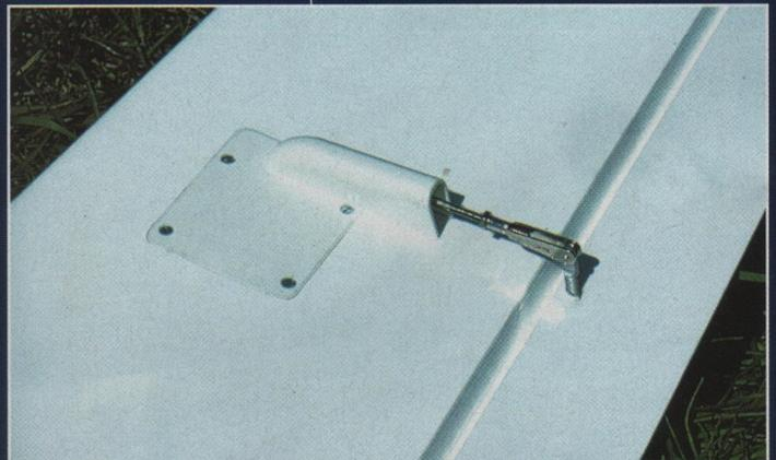
30/10 qui portent le fuselage. La notice est très claire à ce sujet. Je me permets simplement de rappeler que, dans un montage en clé flottante, la clé ne touche pas le fuselage, seuls les quatre tétons assurant la liaison ailes/fuselage. La clé est en l'occurrence un barreau d'acier traité de 12 mm de diamètre d'une solidité surprenante ; il est traité anticorrosion, mais ce n'est pas de l'innox.
