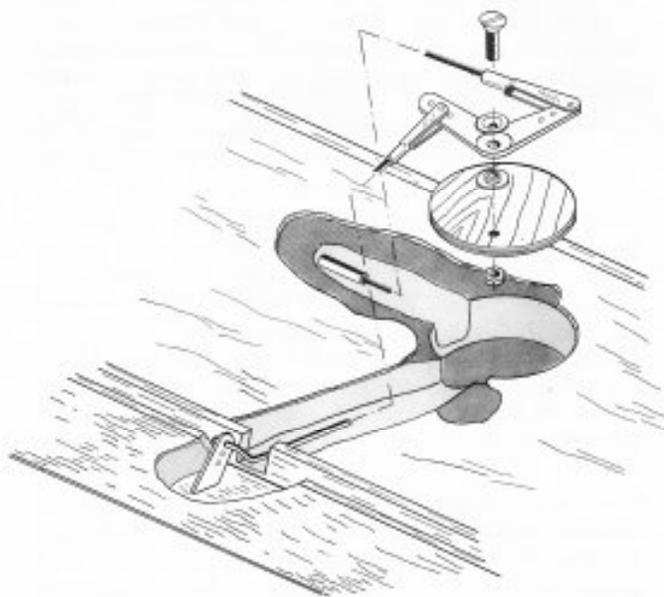
Vor dem Einbau der Hebel muß -wie in der Zeichnung gezeigt- im Bereich der Umlenkung etwas Styropor entfernt werden. Hierbei vorsichtig vorgehen, damit der Tragflügel nicht beschädigt wird.
