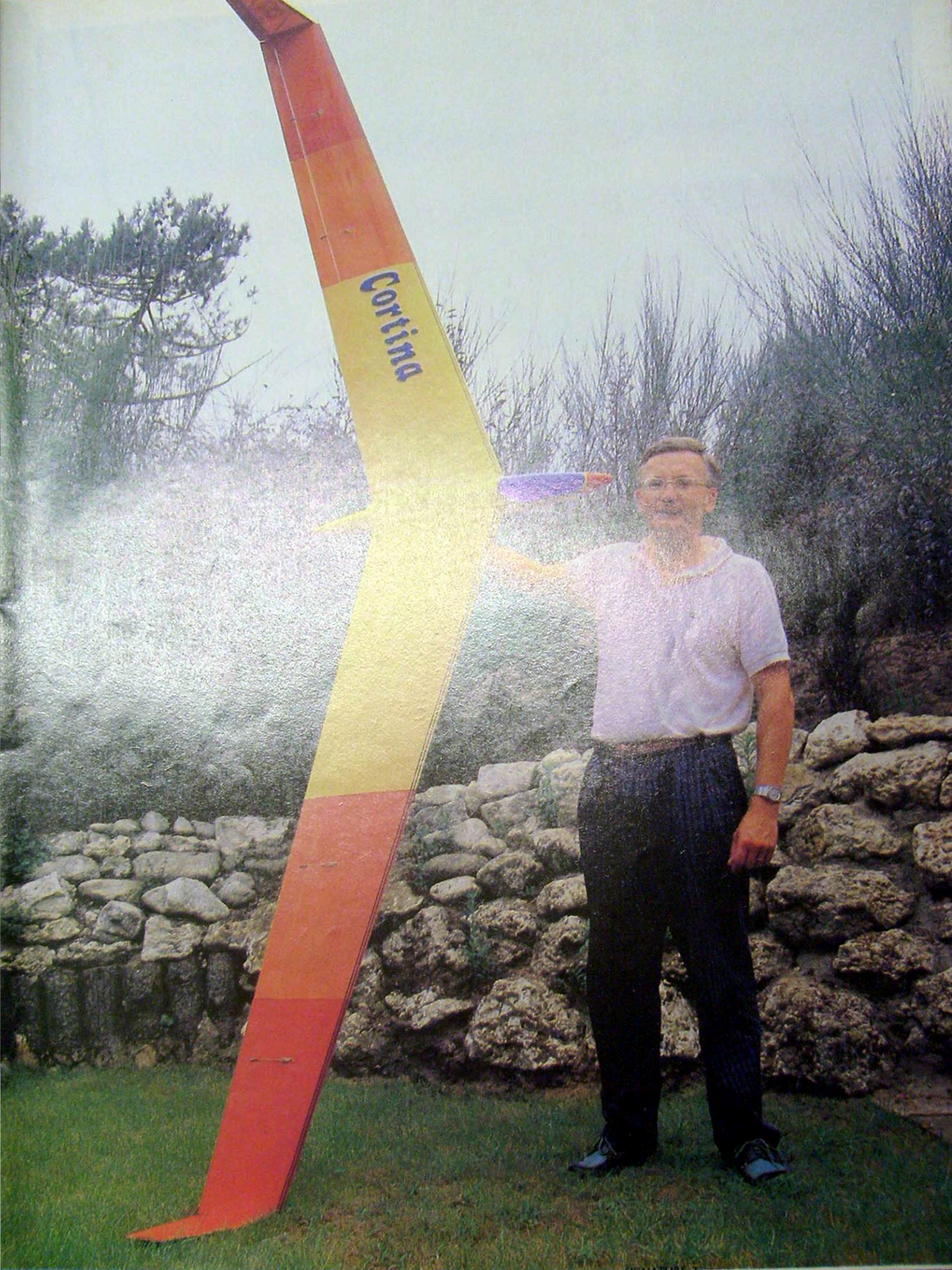
Parmi les petites modifs apportées à la Cortina : les dérives de bout d'aile réalisées en structure et d'une surface légèrement agrandie, les sorties des commandes à l'extrados, et la soute à lest aménagée à l'avant du fuselage. A droite, l'auteur et la bête qui se révèle être une grande plume originale.
