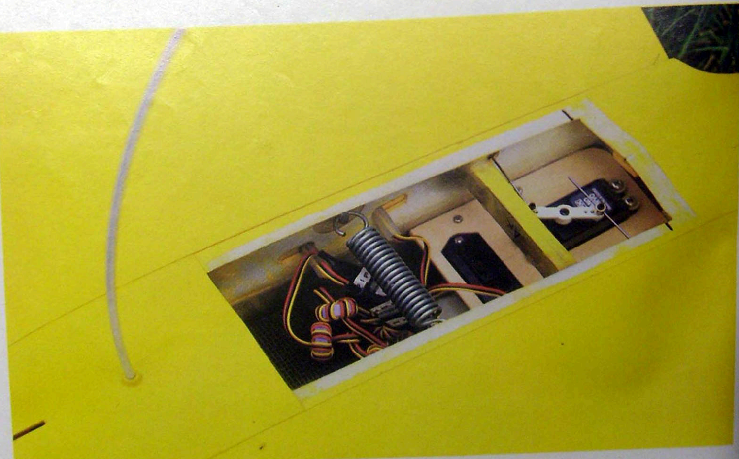
Photo ci-dessus : le tube rigide renforceur du fuselage qui permet de loger l'antenne bien déployée. Ci-dessous le fuselage ne renferme en fait que deux servos : celui des aérofreins que l'on voit ici et celui du crochet de remorquage. Les servos d'ailerons et de profondeur sont logés dans les ailes et raccordés au récepteur via des rallonges dont une partie bobinée autour d'un tore en ferrite pour éviter tout parasite.
