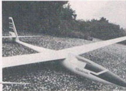
Les stabilisateurs sont montés sur des CAP 20/10 ce qui est suffisant car jamais le stab n'a bougé en vol.
